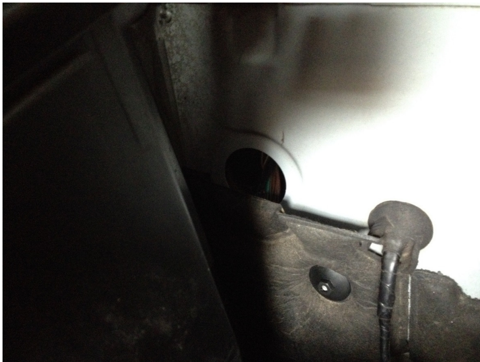
het gat markeert de locatie van de rubber tule
