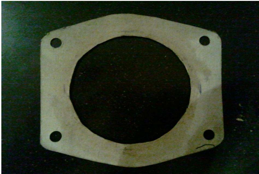
Foto's van de verloopplaatjes onder de inlaatbrug zaten al in de openings-post, dit is de mal voor de verloopplaat tussen gasklephuis en inlaatbrug
