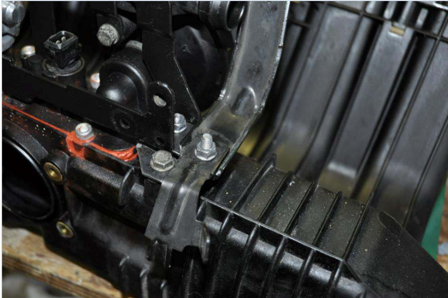
Detailaanzicht van verloopbeugel-op-z'n-plek. Komt nauwer dan je denkt: aan het bovenste opgelaste boutje komt de peilstok vast te zitten...
