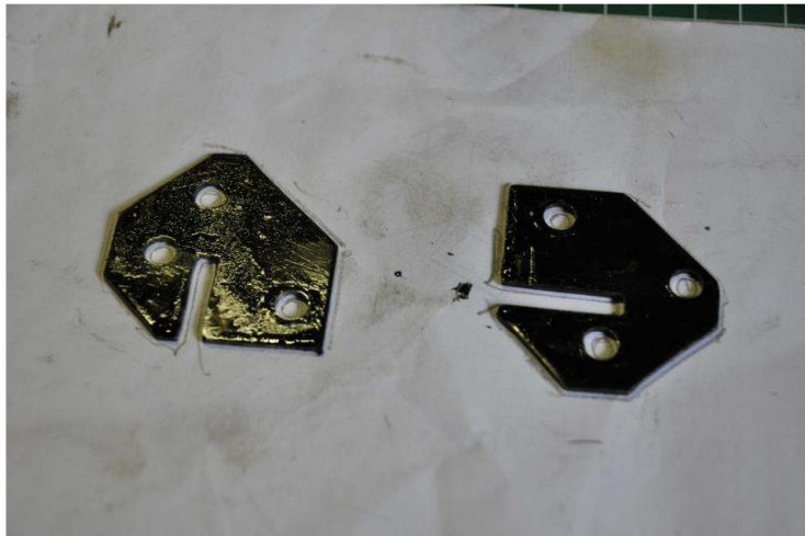
Creatief met staal: de verloopplaatjes die onder de inlaatbrug komen
