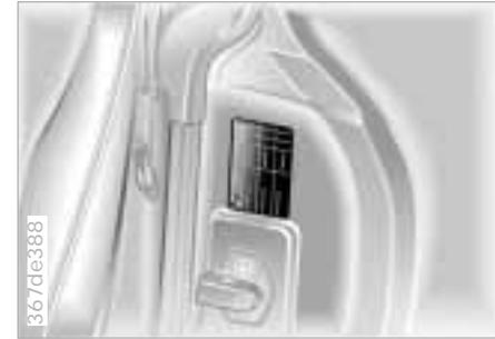
Die Druckangaben in bar (Überdruck) finden Sie auch bei geöffneter Fahrertür an der Türsäule.
