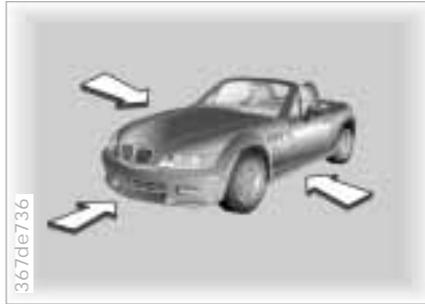
Das Bild zeigt schematisch die Hauptrichtungen, auf die die Airbags im Falle eines Aufpralls des Fahrzeugs reagieren.
