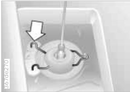
Den Hebegriff nach oben ziehen, bis Ersatzradschale leicht angehoben wird, gleichzeitig die Sicherungsfeder (Pfeil) zusammendrücken. Dadurch löst sich das Ersatzrad (Gewicht ca. 4 kg) und muss mit dem Hebegriff gehalten werden.
