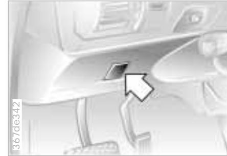
Zugang zur Steckdose für die On-Bord-Diagnose OBD:
