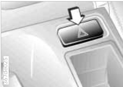
Die Taste leuchtet bei eingeschalteter Warnblinkanlage periodisch auf.
