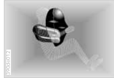
Verzögerungssensoren überprüfen laufend die auf das Fahrzeug wirkenden Beschleunigungen. Wird aufgrund eines Frontalaufpralls eine Verzögerung erreicht, bei der die Schutzwirkung der Sicherheitsgurte alleine nicht mehr ausreichen würde, werden die Gasgeneratoren der Front-Airbags auf der Fahrer- und Beifahrerseite gleichzeitig gezündet. Der Beifahrer-Airbag wird jedoch nur dann ausgelöst, wenn ein weiterer Sensor erkannt hat, dass sich eine Person auf dem Beifahrersitz befindet.
