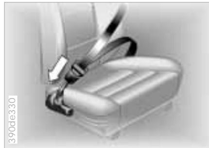
Der Gurtschlossstrammer sorgt dafür, dass bei einer Kollision der Gurt deutlich fester anliegt und den Körper sicher im Sitz hält. In Sekundenbruchteilen wird das Gurtschloss mit Hilfe von Gasdruck zurückgezogen, Schulter- und Beckengurt werden dadurch gleichzeitig gestrafft. So wird einem Durchrutschen unter den Beckengurt weiter entgegengewirkt.
