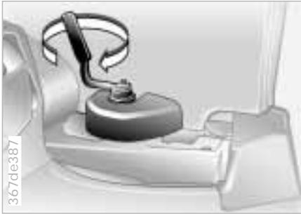
Verriegelungshebel der hinteren Hardtopbefestigung links und rechts in Pfeilrichtung bis Anschlag verriegeln.
