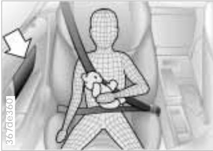
Das Bild zeigt die richtige Sitzposition eines älteren Kindes, gesichert mit dem Sicherheitsgurt, bei Ausstattung des Fahrzeugs mit Seiten-Airbags\* (Pfeil).
