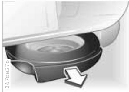
Aufnahmeschale mit Ersatzrad nach hinten aus der Ersatzradhalterung vollständig herausziehen.
