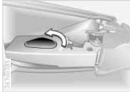
Die Abdeckung, die sich in der Verkleidung rechts und links hinter den Sitzen befindet, in Pfeilrichtung drehen, bis die Öffnung für die Hardtopaufnahme vollständig frei ist.
