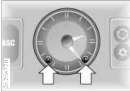
Die Korrektur der Uhrzeit erfolgt durch Drücken der Tasten (Pfeile) mit einem spitzen Gegenstand, z. B. Kugelschreiber.
