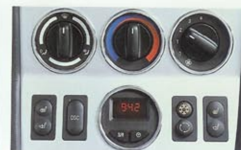
□ Klimaanlage , komfortables Innenraumklima zu jeder Jahreszeit, Luftmengenregelung und Luftverteilung manuell einstellbar (Serie Z3 coupé). Z3 roadster/Z3 coupé
