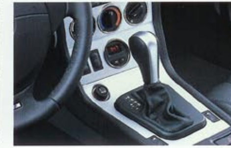
□ Technische Interieuroberfläche in Mattchrom: Mittelkonsole, Schalthebelknopf, Türleisten und die Spange des Sport-Lederlenkrads (Z3 roadster) in Mattchrom sorgen für technisch-moderne Akzente im Innenraum. Z3 roadster/Z3 coupé
