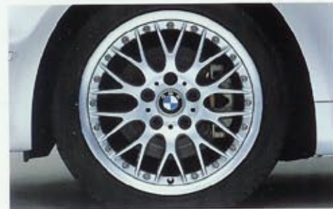
□ BMW Leichtmetallräder Kreuzspeiche Styling 42, geschraubt, mit Mischbereifung, vorn 7,5 J x 17 Zoll, Bereifung 225/45 R 17, hinten 8,5 J x 17 Zoll, Bereifung 245/40 R 17. Z3 roadster/Z3 coupé
