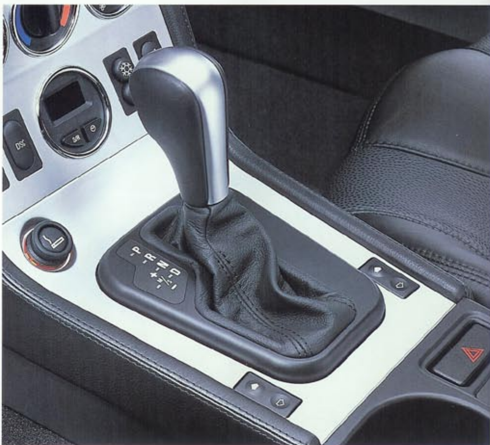
□ 5-Gang-Automatic (hier abgebildet am Z3 roadster) mit Steptronic, Adaptiver Getriebesteuerung (AGS), Shift-/Interlock; mit der Steptronic lässt sich das Automatikgetriebe wahlweise auch wie ein Schaltgetriebe (ohne zu kuppeln) nutzen (nicht erhältlich für Z3 roadster 1.9i). Z3 roadster/Z3 coupé
