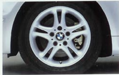
■ BMW Leichtmetallräder Doppelspeiche Styling 47, 7 J x 16 Zoll, Bereifung 225/50 R 16. Z3 coupé
