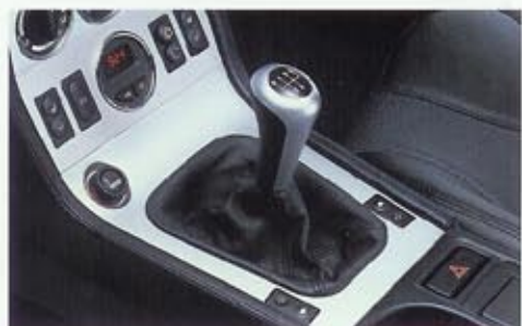
■ 5-Gang-Schaltgetriebe (hier abgebildet am Z3 roadster) zeichnet sich durch Leichtgängigkeit, perfekte Abstufungen und exakte, kurze Schaltwege aus. Z3 roadster/Z3 coupé
