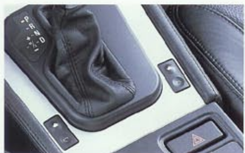
■ Fensterheber elektrisch, inkl. Komfortschaltung über Türschloss; beim Abschießen des Fahrzeugs (Z3 coupé: etwas längeres Drücken der Taste für Zentralverriegelung im Schlüssel; Z3 roadster: nur mit Schlüssel im Schloss) fahren noch geöffnete Türseitenscheiben automatisch hoch. Z3 roadster/Z3 coupé
