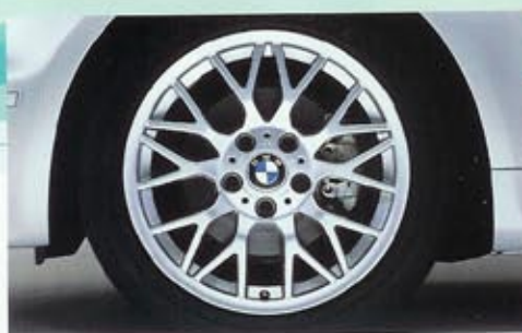
LM-Rad Styling 78: Das LM-Rad Styling 78 mit Mischbereifung ist vorn in der Dimension 7,5 J x 17 Zoll ausgeführt, hinten in 8,5 J x 17 Zoll. Die Reifengröße: vorn 225/45 R 17, hinten 245/40 R 17.
