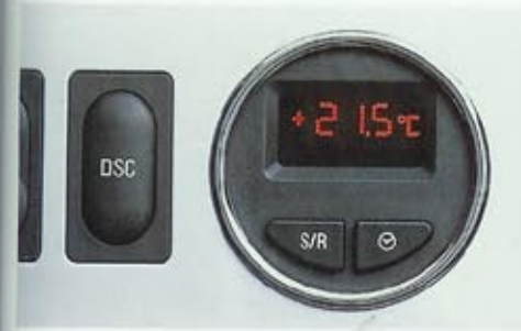
□ Bordcomputer informiert über Durchschnittsgeschwindigkeit, Durchschnittsverbrauch, Reichweite, Außentemperatur und Uhrzeit (Analoguhr serienmäßig). Z3 roadster/Z3 coupé
