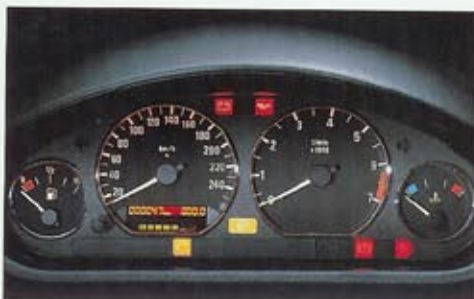
■ Instrumententafel mit Analoginstrumenten (serienmäßig mit Chromringen) und roter Durchlichtbeleuchtung, Drehzahlmesser, Tankuhr, Kühlmittelthermometer, LC-Display für Kilometer- und Tageskilometerzähler. Z3 roadster/Z3 coupé
