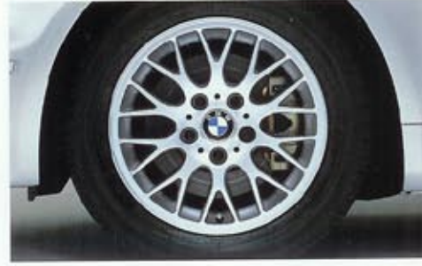
□ BMW Leichtmetallräder Kreuzspeiche Styling 42, 7 J x 16 Zoll, Bereifung 225/50 R 16. Z3 roadster
