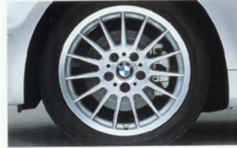
□ BMW Leichtmetallräder Radialspeiche Styling 32 mit Mischbereifung, vorn 7,5 J x 17 Zoll, Bereifung 225/45 R 17, hinten 8,5 J x 17 Zoll, Bereifung 245/40 R 17. Z3 roadster/Z3 coupé
