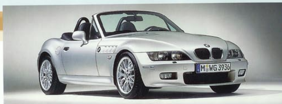
Sportfahrwerk: Das Sportfahrwerk ermöglicht Fahrspaß pur, die Frontschürze mit dem feinmaschigen Gitternetz (für Sechszylinder) im Kühlluft einlass lässt den Z3 roadster sehr kraftvoll aussehen. Ein Sperrdifferenzial (25 %) unterstützt die sportlichen Qualitäten des BMW Z3.
