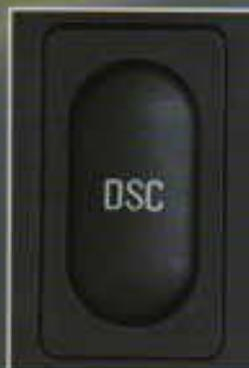
Die auf Wunsch erhältliche Dynamische Stabilitäts Control (DSC), inkl. ADB und DBC, gewährleistet ein Höchstmaß an Fahrstabilität. Sie bezieht alle vorgelagerten Fahrwerksregelsysteme wie ABS oder ASC+T ein und erkennt
