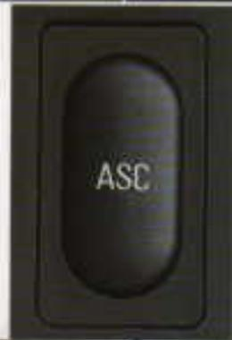
Die Automatische Stabilitäts Control + Traktion (ASC+T) verhindert auf rutschigem Untergrund ein Durchdrehen der Antriebsräder und sorgt in Kurven oder beim Anfahren für sicheren Grip.
